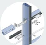
型材立柱与横梁之间采用栓接结构，无焊接，安装方便的同时能确保在受火时释放构件的形变，从而达到 60 分钟的防火完整性要求。
